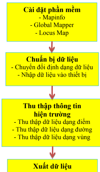
Hình 01. Sơ đồ thực hiện công tác thu thập dữ liệu hiện trường bằng ứng dụng Locus Map trên máy tính bảng, điện thoại thông minh
