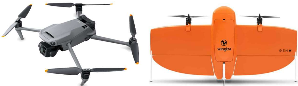
Hình 2. Hình ảnh máy bay không người lái Mavic 3 (ảnh trái) và WingtraOne GEN II (ảnh phải) được sử dụng để bay chụp ảnh trong nghiên cứu
